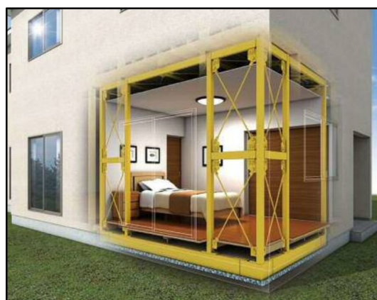
図 耐震シェルターの設置
